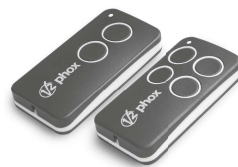
FOX 2; 4-tlačítkový dálkový rádiový ovladač, 433,92 MHz
