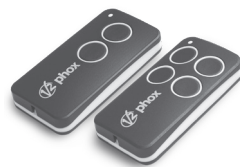
FOX 2; 4-tlačítkový dálkový rádiový ovladač, 433,92 MHz
