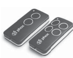
FOX 2; 4-tlačítkový dálkový rádiový ovladač, 433,92 MHz
